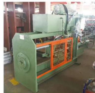
拉丝机 Hook Debeader 将废轮胎胎圈里的的钢丝直接拉出来。 Pull out the wires directly from the tire bead.
