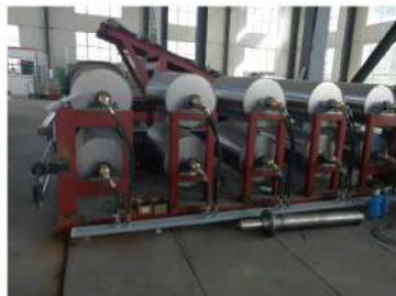
辊筒冷却式 roller cooling type
